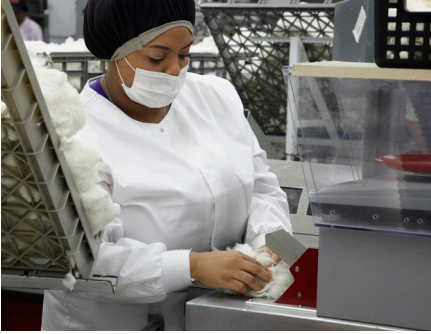
Micronaire được xác định bằng thiết bị đo lượng độ thấm khí.
