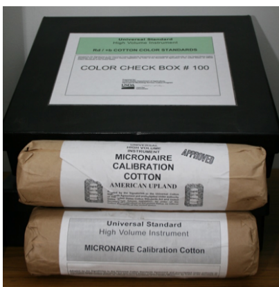
Các ví dụ của bông tiêu chuẩn dùng hiệu chỉnh thiết bị phân loại về màu sắc và độ mảnh cho máy HVI.
