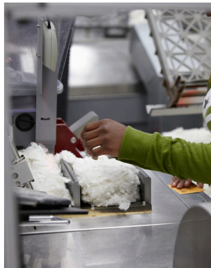
Độ màu bông được phân cấp bằng máy HVI.
