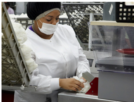
马克隆值通过气流仪测量纤维的透气率而获得
