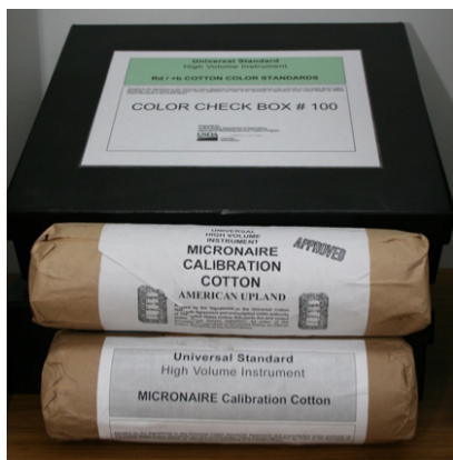
大容量测试仪通用棉花颜色标准及马克隆值标准校准棉样
